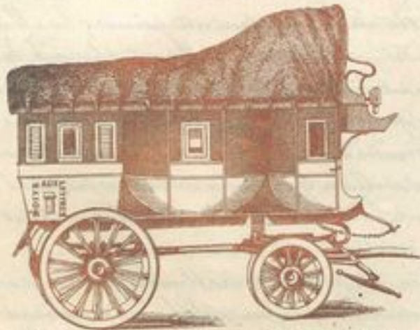
Voiture publique vue de côté avec la boîte aux lettres figurée au panneau latéral de l'arrière-train.
